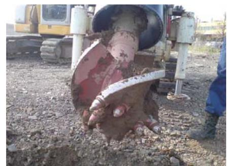
写真-3 使用した破碎ビット
