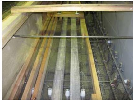
写真.2 実物大試験体への打設
