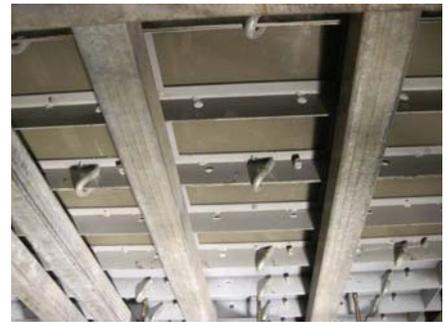
写真.3 実物大試験体への打設
