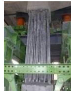
写真 2 鋼管内コンクリートはつり後
