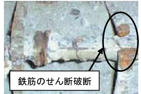
写真-1 曲げ加工部でのせん断破断例
