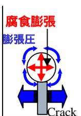
図 - 6 腐食ひび割れ発生メカニズム
