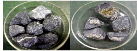
写真-2 回収された粗骨材（左 20%, 右 15%）
