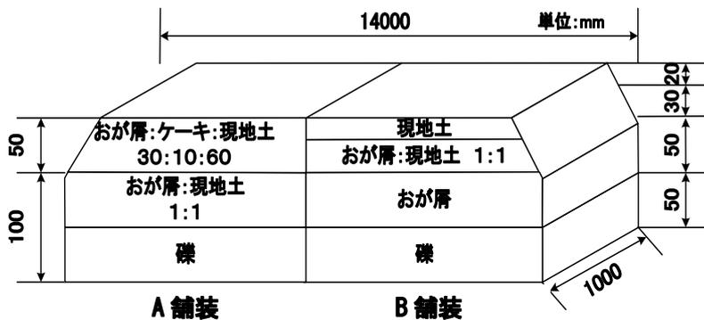
図-1 ウォーキング歩道の舗装構造
