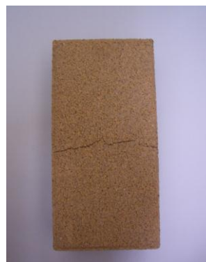
写真-1 ひび割れた WRB (38 サイクル)
