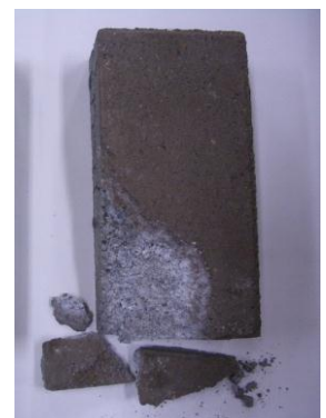
写真-2 ポップアウトした NCB (185 サイクル)
