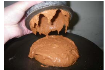
写真 2 RH による粘着性発現の様子 (配合 RH-20)
