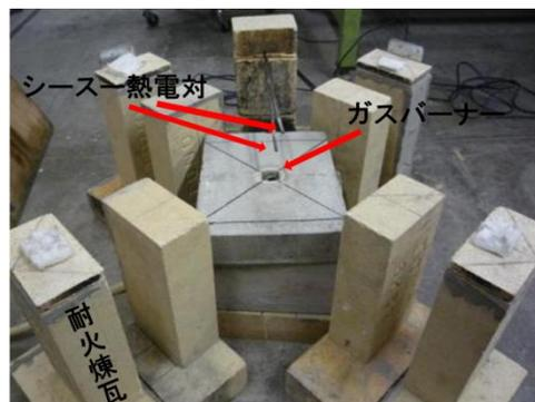
写真1 加熱システム概要
