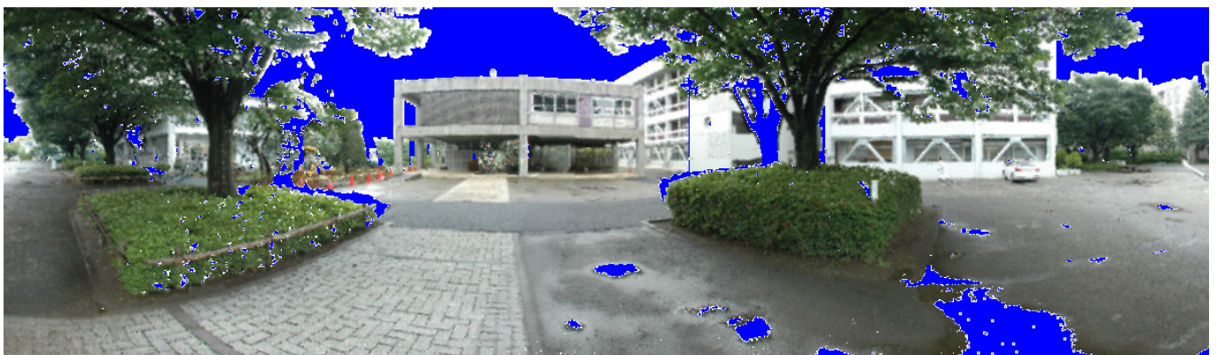
図 5. 視点移動および空間補間後の LiDAR VR (レンジ画像) の一部
