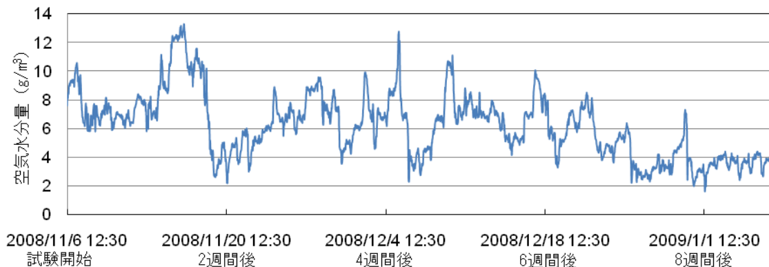
図-16 暴露時間に伴う空気水分量の変化の推移(CASE2)
