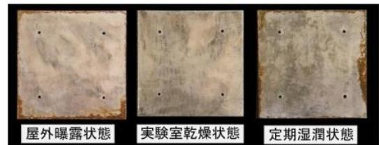
図-4 鋼板の腐食状況 (180日後)
