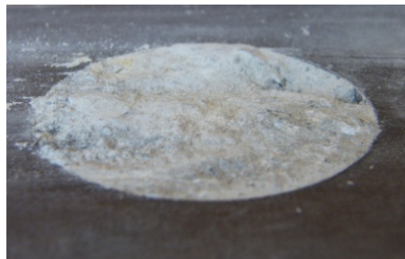
写真-2 B4H4NB-2 ジベル孔内破壊面
