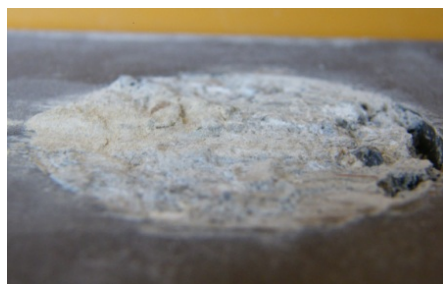
写真-1 B4H4NB-1 ジベル孔内破壊面
