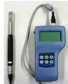
図-3 熱線風速計
