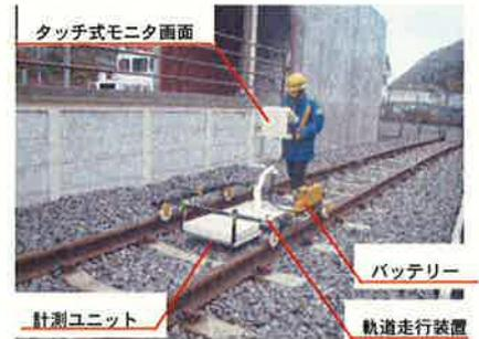
図-1 可搬型線路下空洞探査装置
