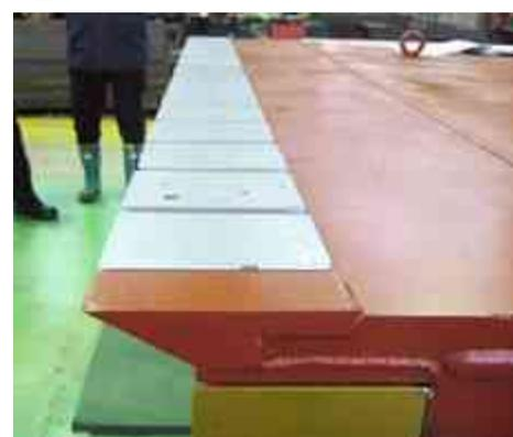
写真-1 ビット取替え後（余掘り用替刃）
