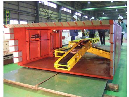
写真1 薄型ベルコンを設置した状態
