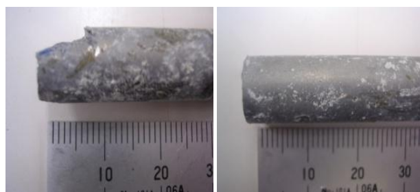
図-3 No.2 (左) と No.5 (右) の脱錆前の外観図
