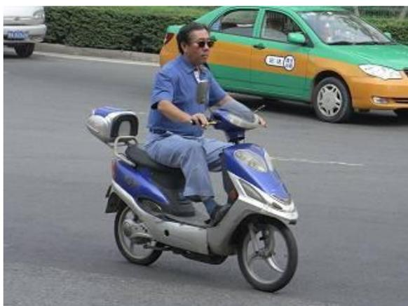
写真-9 スクータを電動化した電動自転車
