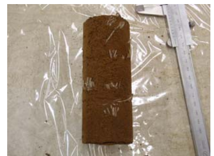
写真－3 短繊維混合の供試体
