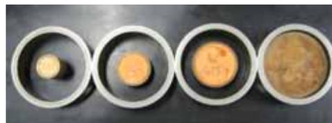
写真-1 圧密リングと加圧板
