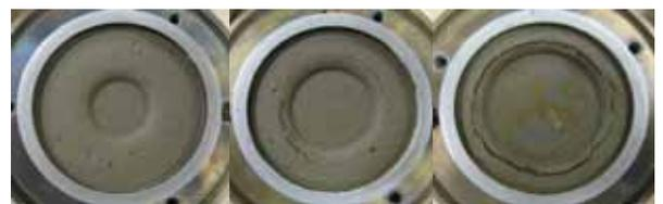
写真-2 試験後の圧密リングと供試体 (左から直径 2cm, 3cm, 4cm)
