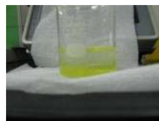
写真-5 鉛汚染対策効果 (酸化カルシウム 20%)
