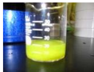
写真-2 汚染土壌における鉛の溶出
