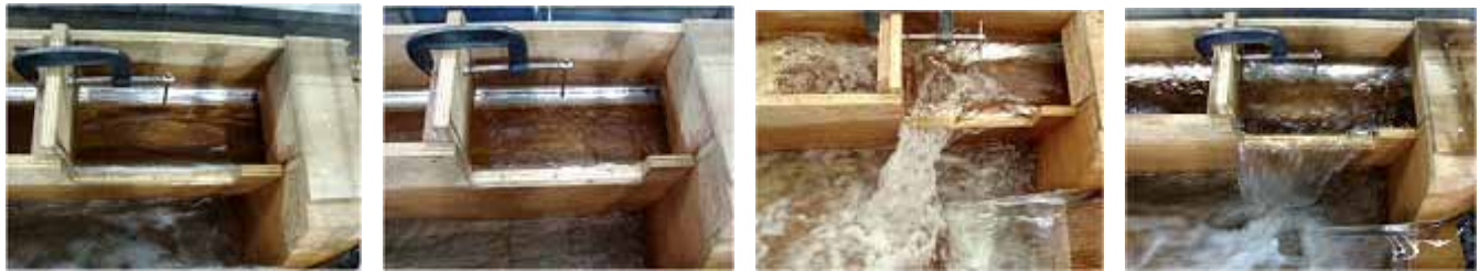
(a) 流況 E(魚道内射流) (b) 流況 E(魚道内常流) (c) 流況 F(偏向した越流) (d) 流況 G(越流水脈が乱れず) 写真5 余水吐きから越流する流れ
