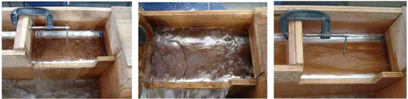
(1) (常流の流れ) 流況 A (2) 跳水(潜り跳水を含む) 流況 B (3) (射流の流れ) 流況 C 写真4 オリフィス板上流部の流況
