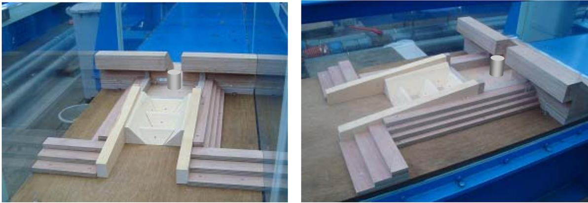
写真2 堰下流部に設置する魚道工の提案模型
