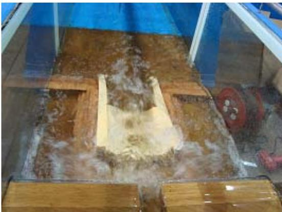
(e)  $Q = 9.3 \text{ m}^3/\text{s}$  時の流況(上流側から見た流況)
