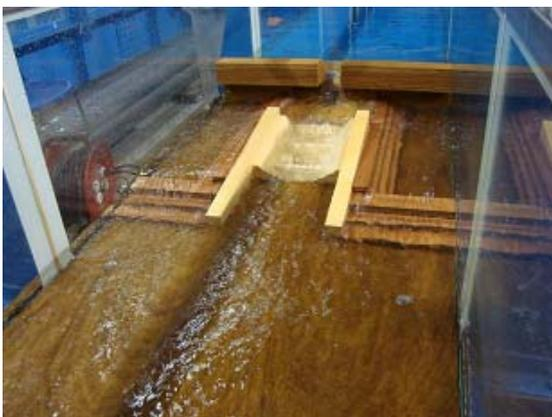
(a) 通常時の流況( $Q = 1.8 \text{ m}^3/\text{s}$  時の流況)
