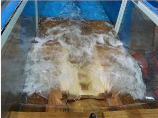
(c)  $Q = 34 \text{ m}^3/\text{s}$  時の流況(上流側から見た流況)
