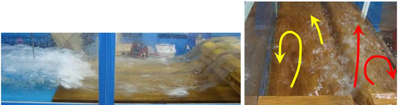
(a) 露出射流が形成される流況( $Q = 66 \text{ m}^3/\text{s}$  時の流況の推定) (b) 偏向流況( $Q = 5.7 \text{ m}^3/\text{s}$  時の流況の推定)
