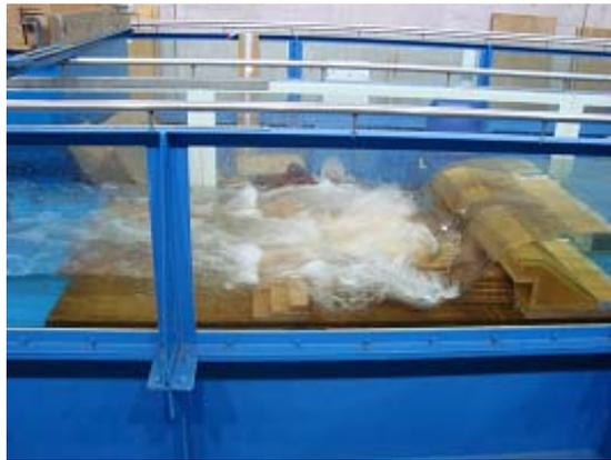
(d)  $Q = 34 \text{ m}^3/\text{s}$  時の流況(魚道工周辺の流況)
