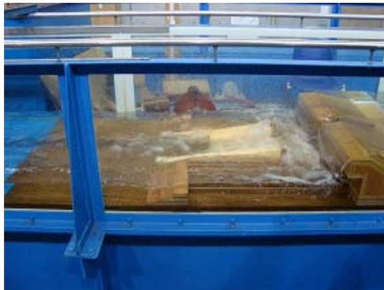
(f)  $Q = 9.3 \text{ m}^3/\text{s}$  時の流況(魚道工周辺の流況)
