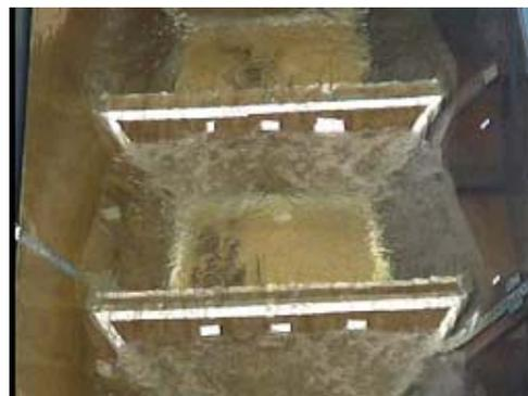
写真4 台形断面魚道模型内に放流し遡上したアユとウグイ(実験条件: 写真1参照)
