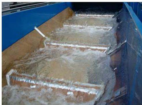
写真1 2分の1縮尺を想定したプール式台形断面魚道模型 (魚道勾配 i=1/10, b=1.4m m=1, S=9cm, h=18cm, Q=0.0315 m<sup>3</sup>/s)
