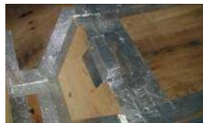
写真3 突起物を設置した 台形断面魚道模型
