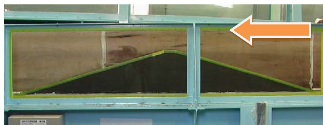
写真 1 矩形断面可傾斜水路
