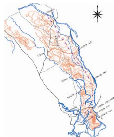
図-2 カスリーン台風で氾濫した氾濫流の流下実績図
