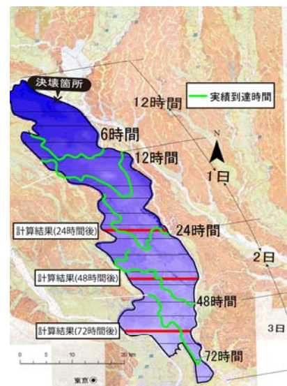
図－４ 実績の氾濫流の流下状況と計算結果
