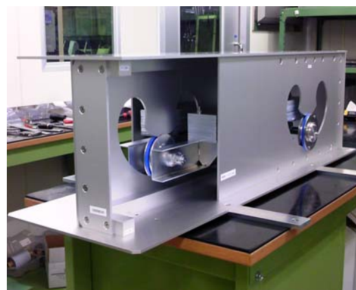
図-1 試作クレイドル型制振装置
