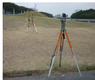
図-6 セオドライトカメラの設置
