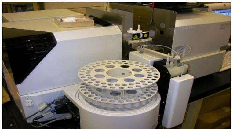
写真2 重金属類の原子吸光分析
