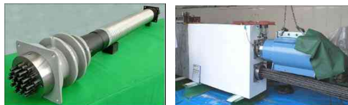
図 - 1 使用した PC ケーブル定着具及び試験体状況
