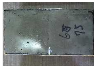
図-2 ひび割れ導入後の試験体
