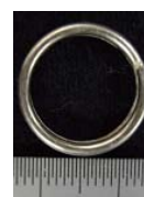
図 - 2 φ13mmの鋼リング
