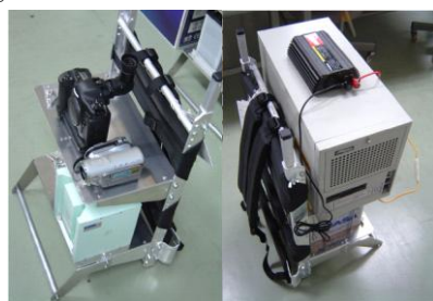
撮影部 コントロール部 図-1 慣性写真測量装置
