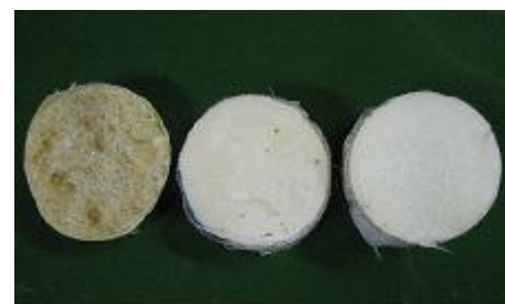
(a) 布パッカーのみ (b) ビニール付 (c) 空気中 写真-1 作製した発泡ウレタンの断面
