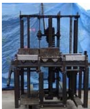
写真1 簡易ブロック作成機
