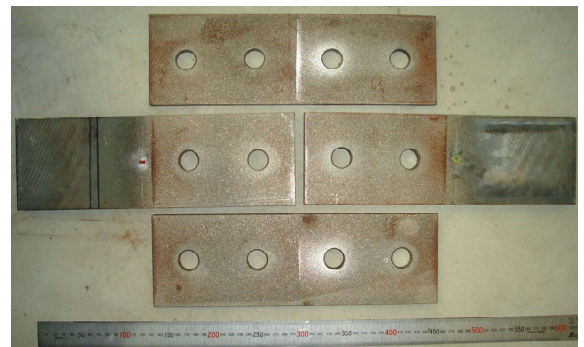
写真-1 解体後の試験体(Sシリーズ)
