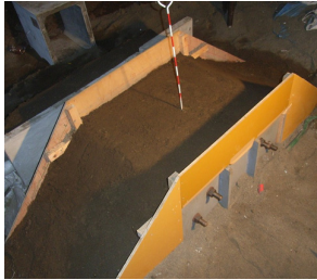
図-3 模型覆土式火薬庫
