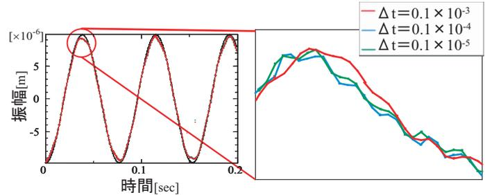
図-4 各  $\Delta t$  での変位応答の数値解析解 (陰解法)
