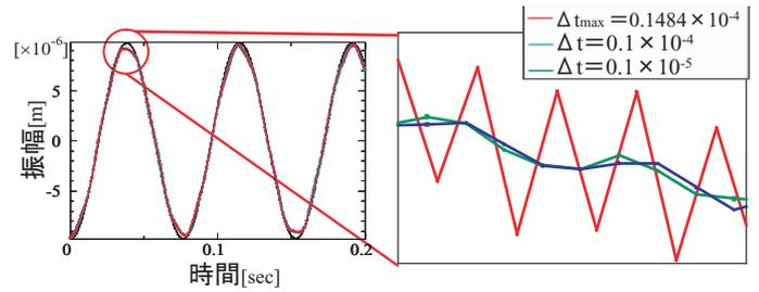
図-3 各  $\Delta t$  での変位応答の数値解析解 (陽解法)
