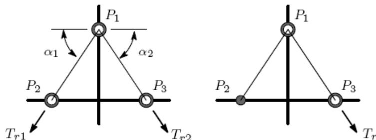
(a)  $P_1$ で左右のケーブルの水平分力が等しくなるような条件を付加し、 $P_2$ と $P_3$ では滑車が鉛直方向に移動しないようなケーブル張力 $T_{r1}, T_{r2}$ を決定する。
