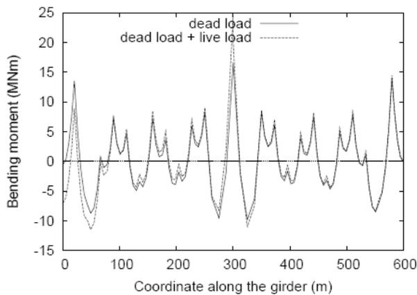
図5 斜張橋の桁の曲げモーメント
