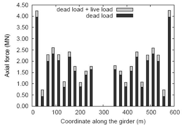
図6 斜張橋のケーブルの軸力
