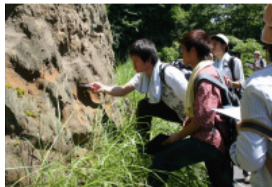
図 2 クリノメータを用いた地層の走向傾斜の測量
