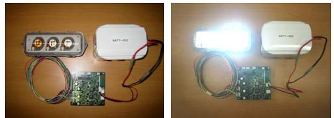
写真-2 LED 投光器 (左: 消灯時, 右: 点灯時)
