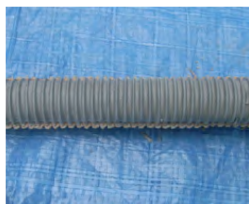
図 4-4 高チクソトロピー性グラウト材 (硬化後)
