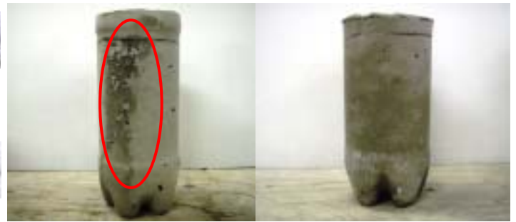
写真-4 脱型後に発生する砂すじ
