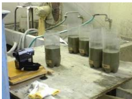
写真-1 下層打込み後のビデオカメラによる撮影状況
