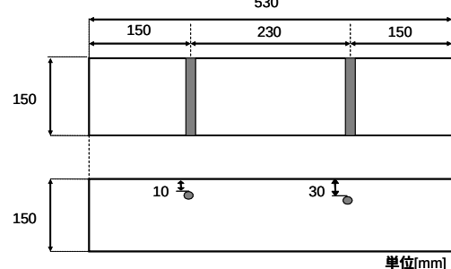
図-2 供試体寸法(透過波測定用 使用鉄筋 D19, D32)
