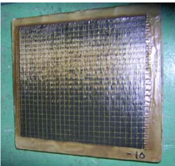
写真-2 温冷繰返し負荷後の試験体
