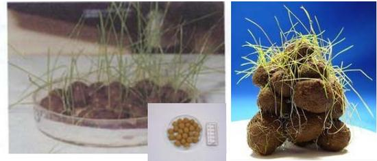
写真-1 植生造粒土写真(左:室内試験. 右:野外試験)
