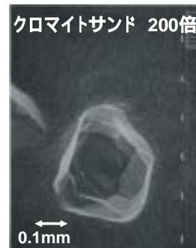
写真-1 顕微鏡写真によるクロマイトサンドの表面形状
